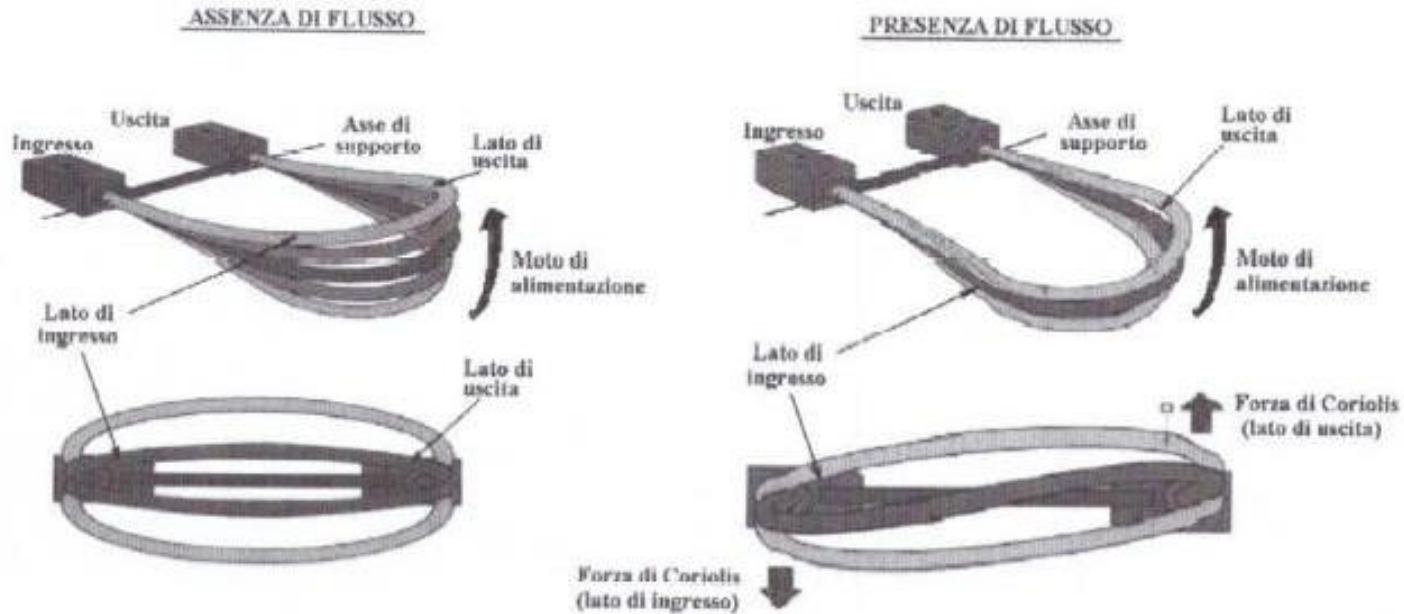
Figura 2.32 – Deformazioni indotte nella tubazione di misura
