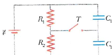
1. Il circuito in figura ha l'interruttore T inizialmente aperto; inoltre:  $\mathcal{E}=24 \text{ V}$ ,  $R_1=20 \Omega$ ,  $R_2=10 \Omega$ ,  $C_1=4 \text{ nF}$  e  $C_2=2 \text{ nF}$ .
