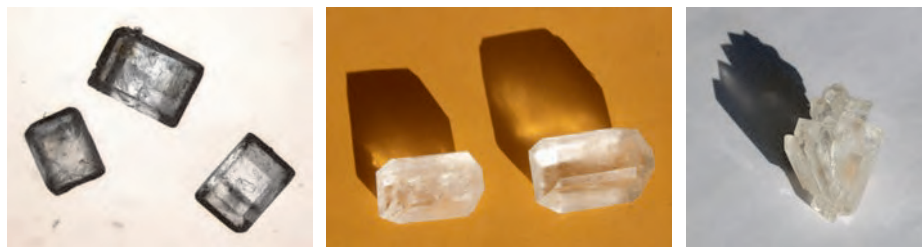
Figura 8.14: A sinistra: piccoli germi ottenuti per evaporazione di una soluzione acquosa di saccarosio. Al centro e a destra: cristalli di saccarosio di ca. 3 cm di lunghezza preparati con 300 cm 3 di soluzione.
