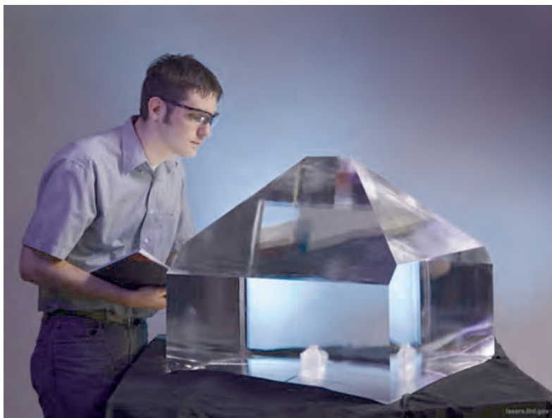
Figura 1.9: Un cristallo di diidrogenofosfato di potassio cresciuto da soluzione acquosa presso il Lawrence Livermore National Laboratory: in basso, al centro del cristallo, si vede il germe iniziale. Per gentile concessione dal materiale divulgativo pk_seven_wonders.pdf del Lawrence Livermore National Laboratory (LLNL), Livermore, California, Stati Uniti.
