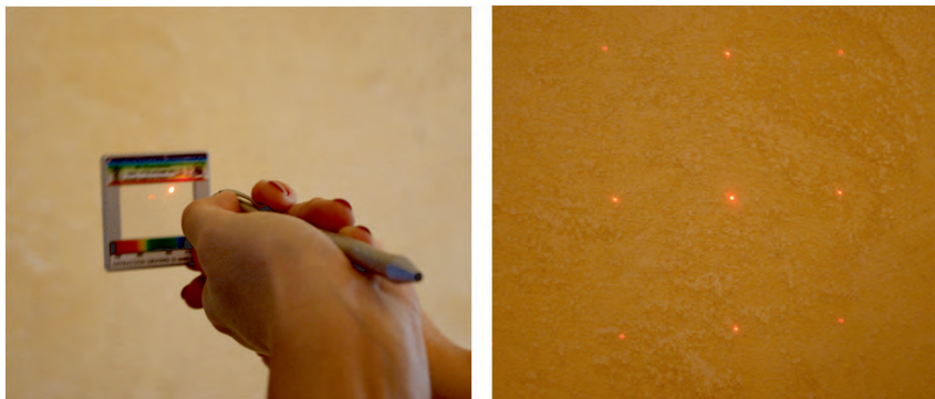
Figura 4.1: Quando la radiazione di colore rosso (con lunghezza d'onda di 0,635 micrometri) emessa da un puntatore laser viene fatta passare attraverso un reticolo bidimensionale la cui trama ha un passo di 2 micrometri (a sinistra) si osserva diffrazione: il fascio laser incidente si frammenta in più componenti, che danno luogo all'immagine che si può apprezzare sulla parete, detta figura di diffrazione (a destra). L'effetto del passaggio della radiazione laser attraverso un reticolo bidimensionale (un insieme ordinato e periodico di fessure nello spazio bidimensionale) è la creazione, quale figura di diffrazione, di un reticolo bidimensionale (un insieme ordinato e periodico di macchie nello spazio bidimensionale). È di importanza estrema il fatto che, noto il passo della figura di diffrazione, si possa ricostruire il passo del reticolo che l'ha generata. Il lettore può provare a generare alcune figure di diffrazione seguendo il filmato disponibile al sito http://richannel.org/collections/2011/tales-from-the-prep-room#/tales-from-the-prep-room-diffraction .
