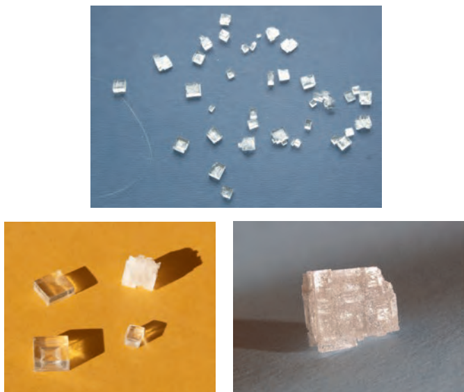
Figura 8.12: In alto: germi cristallini di cloruro di sodio cresciuti per evaporazione del solvente a temperatura ambiente. In basso: a sinistra cristalli limpidi di ca. 1 cm di lato cresciuti lentamente e un cristallo con facce a tramoggia; a destra il cristallo con facce a tramoggia visto a maggiore ingrandimento.
