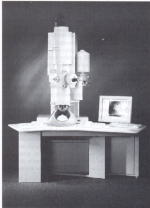
Figura 1.12 Un microscopio elettronico a trasmissione, TEM, Philips Tecnai, prodotto dalla FEI. La struttura centrale verticale è la colonna elettronica con meccanismi di controllo su entrambi i lati e uno schermo di osservazione al livello del tavolo; lo schermo di osservazione è usato per esaminare immagini e figure di diffrazione elettronica. A metà altezza della colonna elettronica, leggermente sulla destra, si trova il portacampioni. Sulla destra è possibile osservare un rivelatore a dispersione di energia (EDX) con un vaso Dewar contenente azoto liquido usato per il raffreddamento del rivelatore. Sulla estrema destra si trovano il sistema computerizzato di controllo ed un monitor per osservazioni e controllo dello strumento.
