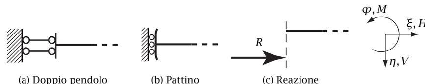
Figura 1.5: Vincoli che impediscono la rotazione e l'incremento di spostamento in una data direzione
