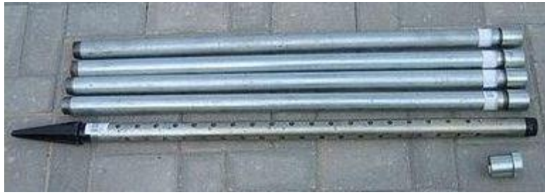
Figura 32 Tubazioni, puntazza e tubo finestrato per la realizzazione di un pozzo a percussione.
