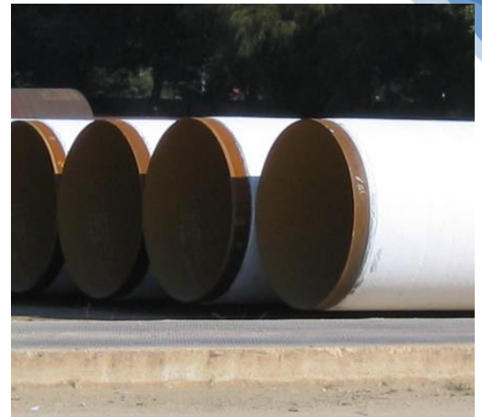
Figura 24 Rivestimento in polietilene a caldo a nastro o estruso UNI 9099 e/o DIN 30670 1
