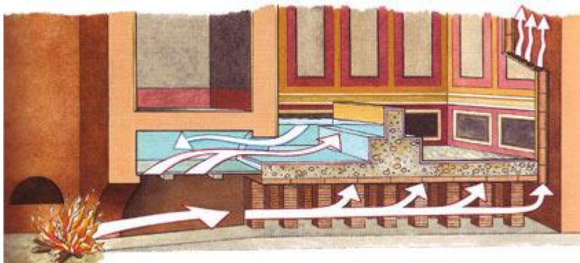
Figura 116 Sistema di riscaldamento a pavimento "ipocausto".
