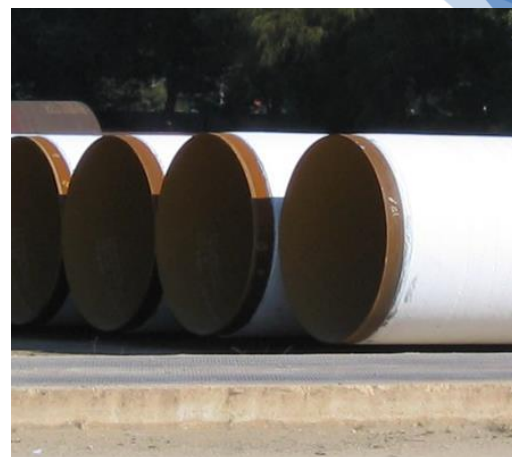
Figura 24 Rivestimento in polietilene a caldo a nastro o estruso UNI 9099 e/o DIN 30670 1
