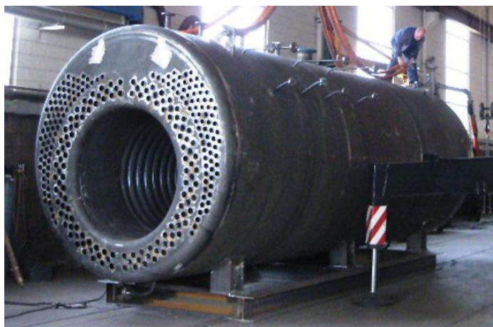
Figura 83 Generatore di vapore a tubi di fumo: il recipiente cilindrico
