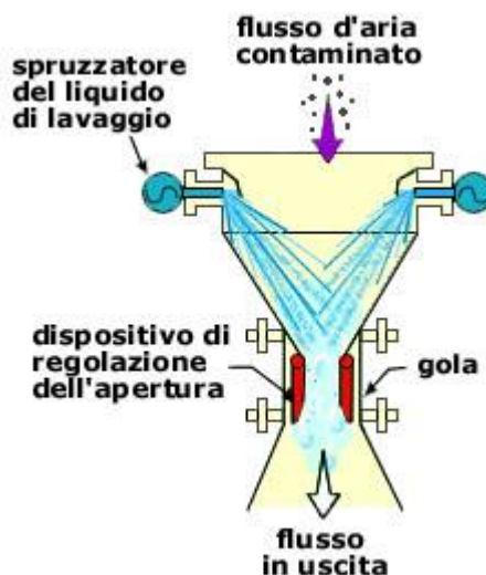
Figura 92 Depuratore Venturi – Principio di funzionamento
