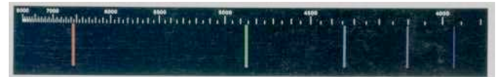
spettro di emissione dell'idrogeno (eccitato precedentemente da scarica elettrica)
