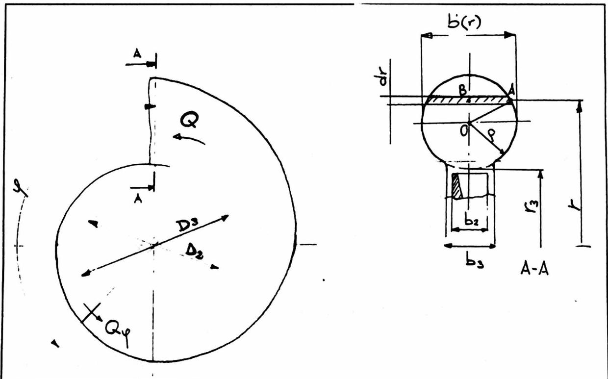
Il diametro  $D_3$  e la larghezza  $b_3$  della sezione di ingresso della voluta si ottengono statisticamente grazie ai rapporti adimensionali  $D_3/D_2$  e  $b_3/b_2$ , ed al numero caratteristico  $K$  della pompa. Di fatto si hanno i seguenti valori estrapolabili linearmente:
