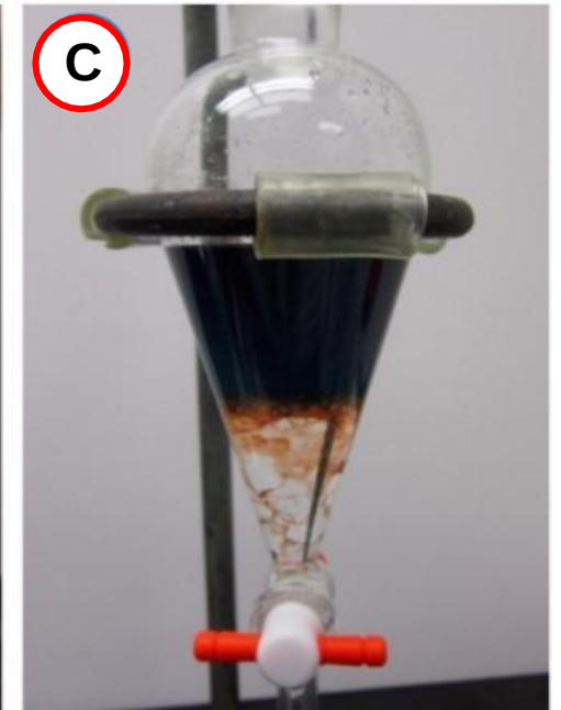
diclorometano - brine con colorante alimentare
