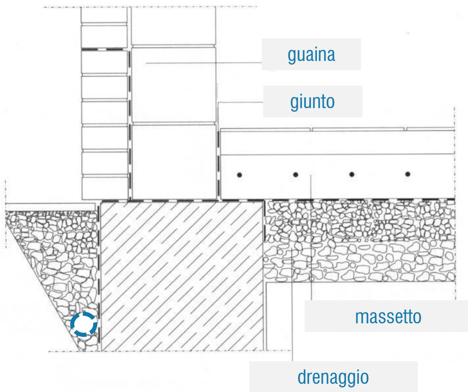
Massetto impermeabilizzato su vespaio
