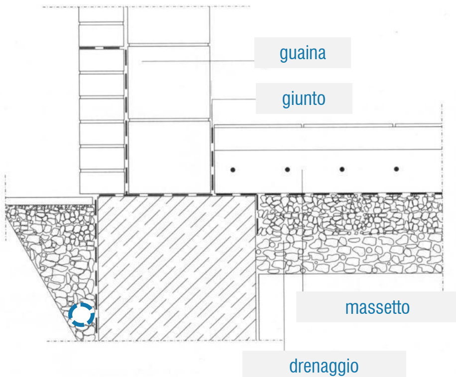
Massetto impermeabilizzato su vespaio
