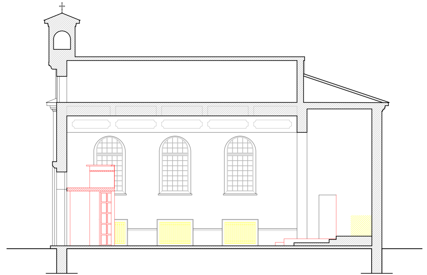
Sezione A-A - demolizioni/costruzioni
