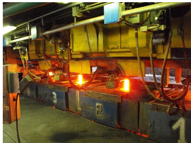
Figura 88 Colata continua (schema)
