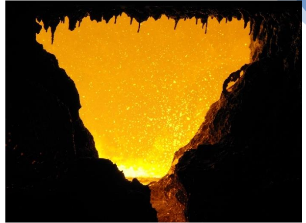
Figura 80 Bagno di acciaio fuso nel forno ad arco
