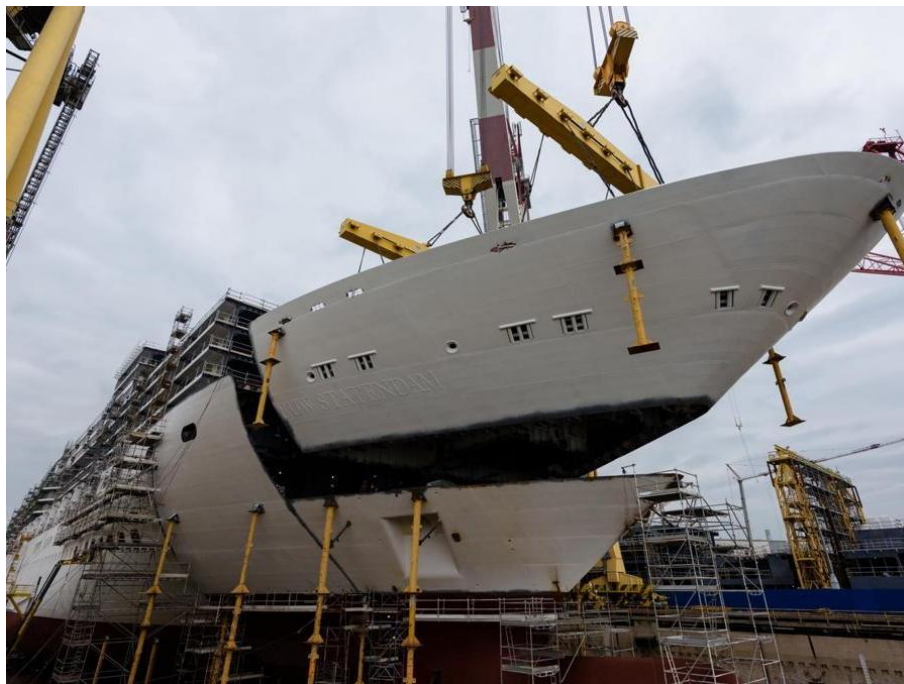
Figura 48 Imbarco della sezione di prua
