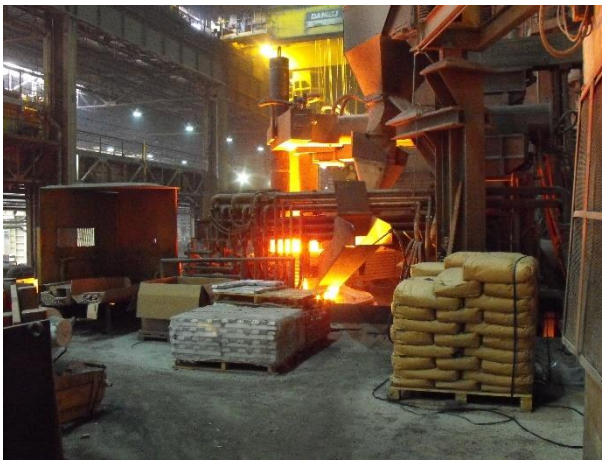
Figura 81 Operazioni di metallurgia secondaria in siviera
