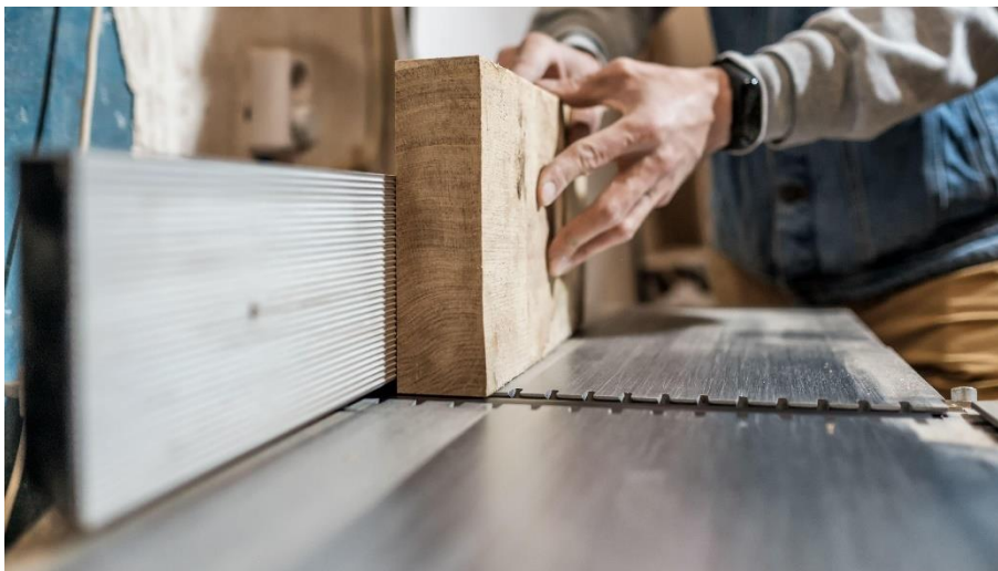
Figura 109 Piallatura a filo: avanzamento manuale del pezzo
