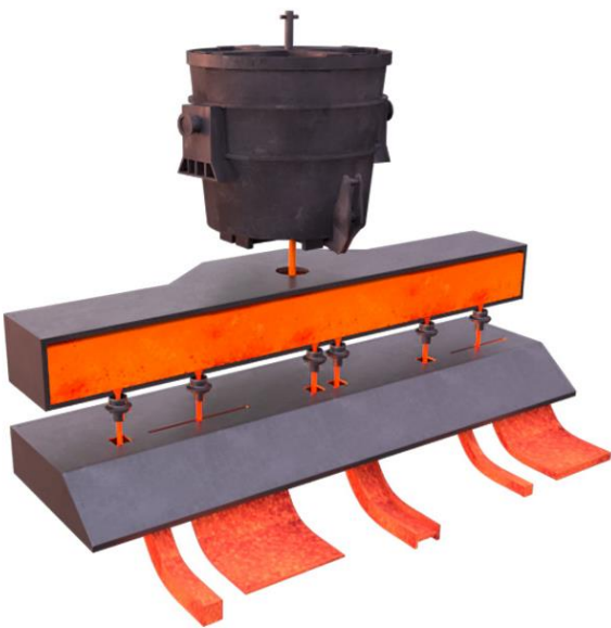
Figura 89 Colata continua: Siviera, paniera, lingottiera
