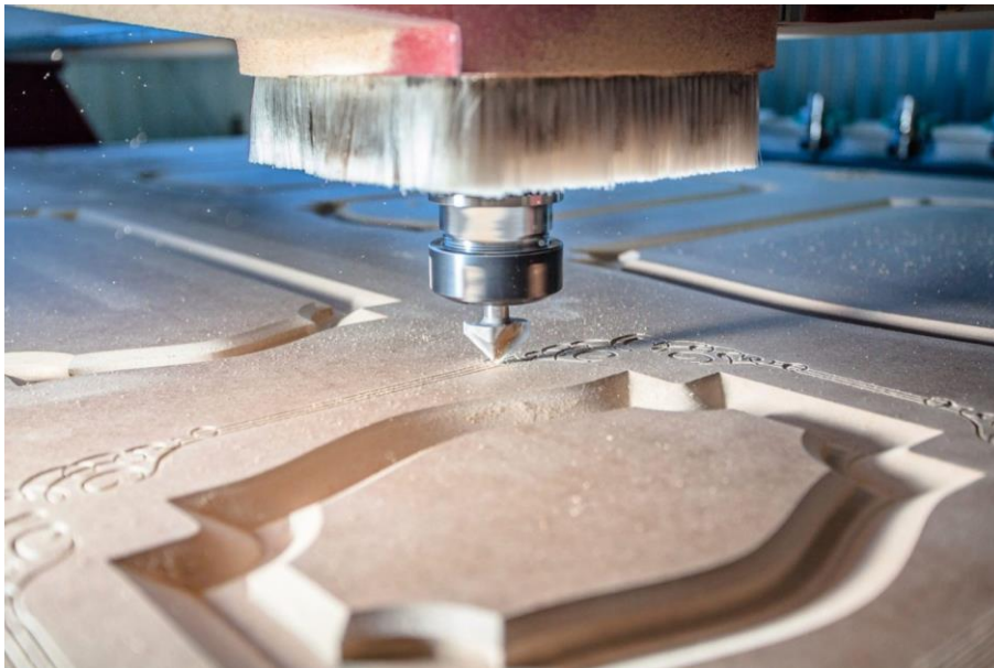
Figura 113 Fresatura di un'anta in un centro di lavoro
