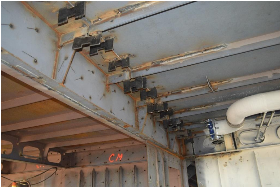
Figura 60 Saldatura di una sezione appena imbarcata
