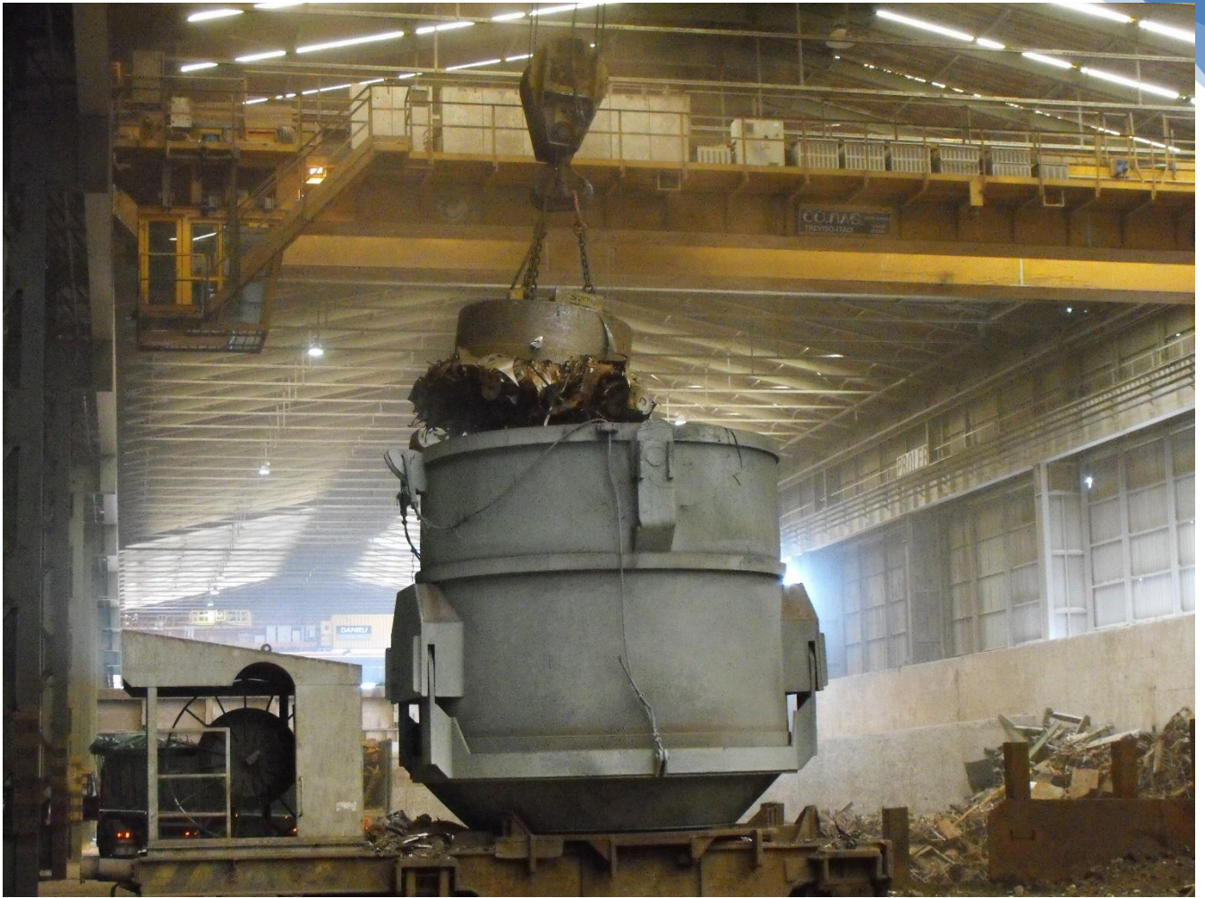
Figura 75 Riempimento della cesta mediante carro ponte dotato di magnete
