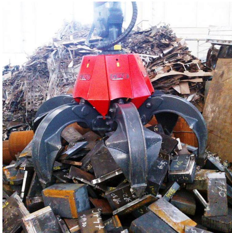
Figura 76 Benna a polipo per la movimentazione di rottame metallico
