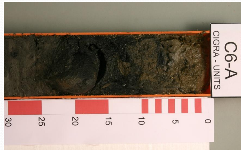
2. Pulizia degli emicilindri con eliminazione residui PVC
