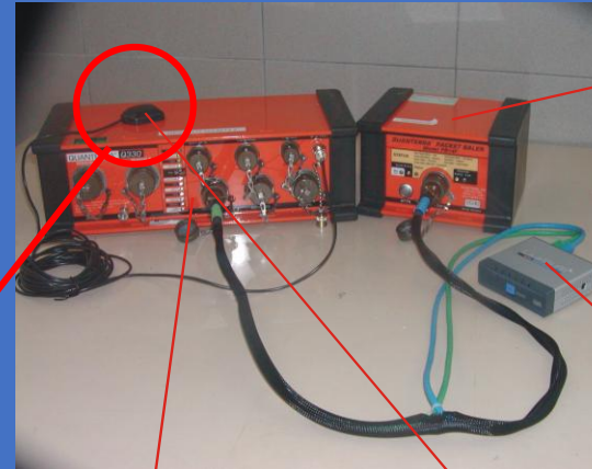
Antenna GPS per la sincronizzazione del tempo tramite satelliti
