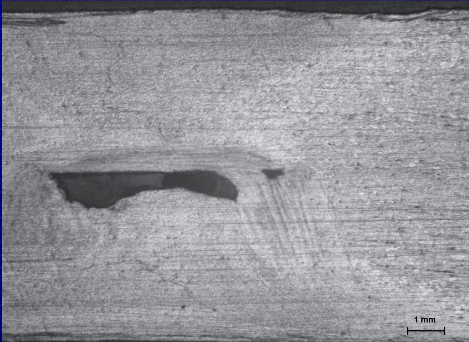
Utensile "A", 2000 rpm, 400 mm/min
