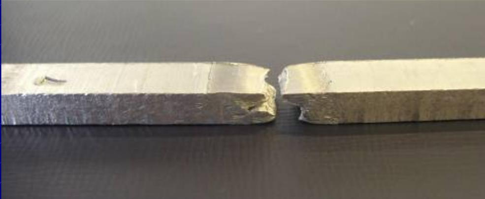
I provini che presentavano un foro, si sono rotti al centro della saldatura.
