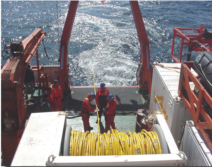
Lo streamer contiene i ricevitori (idrofoni)
