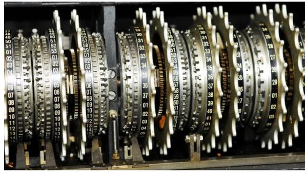
Figure 3: Un dettaglio degli ingranaggi della Lorenz SZ machine.
