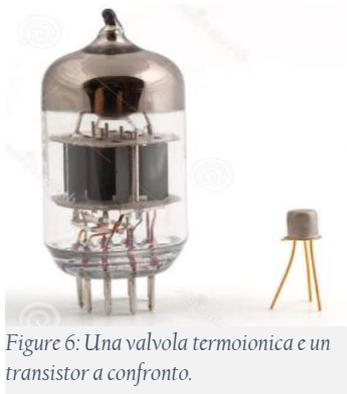
Figure 6: Una valvola termoionica e un transistor a confronto.
