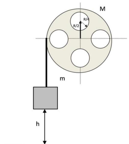
Al disco è avvolta una fune inestensibile e di massa trascurabile, alla cui estremità è appeso un blocchetto di massa  $m = 200 \text{ g}$ . Il valore numerico del momento di inerzia della puleggia è  $I_0 = 0.18 \text{ kg m}^2$ . Al tempo  $t = 0$  il blocchetto, inizialmente fermo, viene lasciato libero di muoversi.
